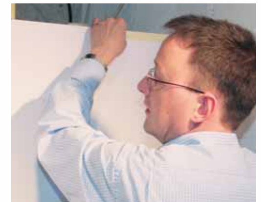
Der Rahmen für die VISIER-Testanlage wurde nach hinten noch mit lose herabhängender Teichfolie bespannt. Heute wählt Bernhard Zeidler transparente Kunststoffmatten, die die Geschosse abfangen und wenig beschädigt werden. Rechts wird der Rahmen vorn mit dünnem Papier bespannt.
